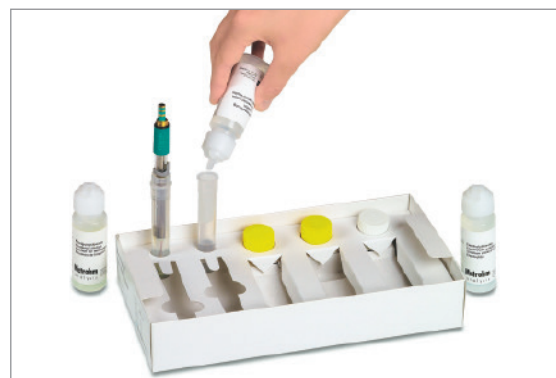
6. Aufbewahrungslösung im Elektrodenköcher erneuern
