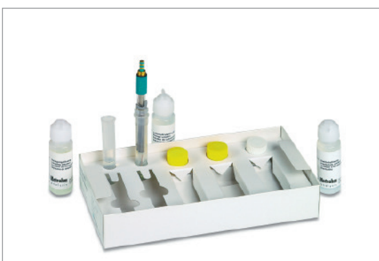
7. Sensor in Aufbewahrungslösung konditionieren
