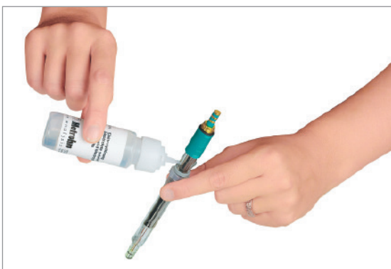
5. Elektrolytkammer mit Elektrolyt spülen und nachfüllen
