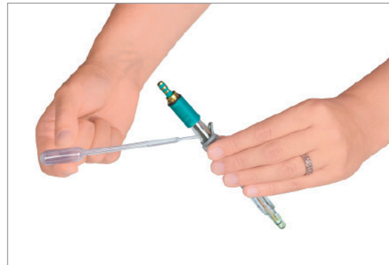
4. Anschliessend Elektrolytkammer entleeren
