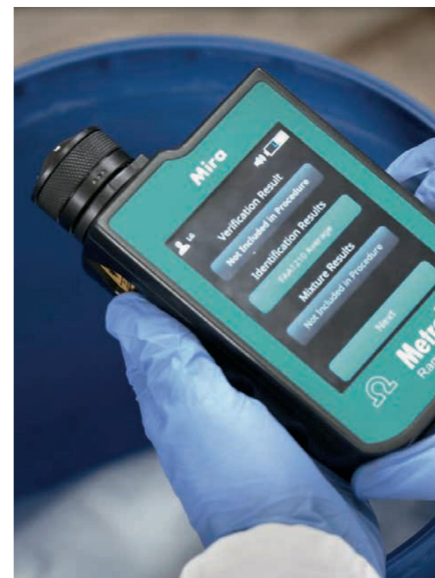
Grâce à la lentille intelligente de MIRA P, il est possible de prélever directement des échantillons de poudres à travers des sacs en plastique translucides.
