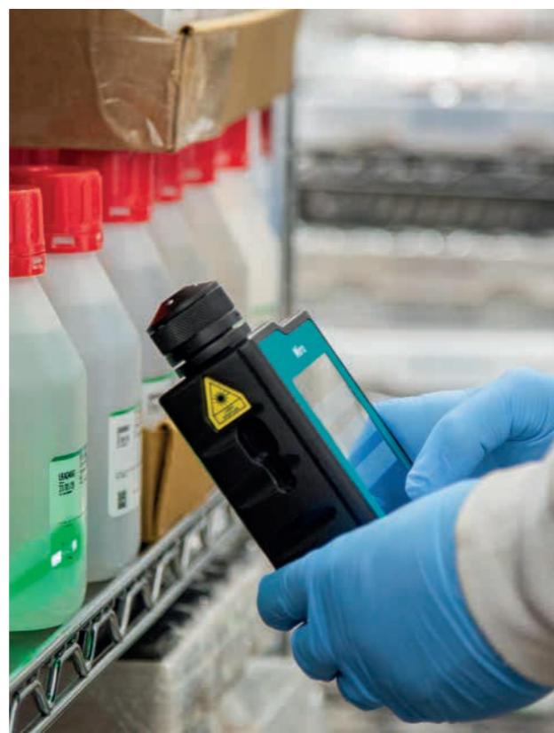
Le lecteur de code-barres intégré permet à MIRA P de tester rapidement l'intégralité d'un lot.
