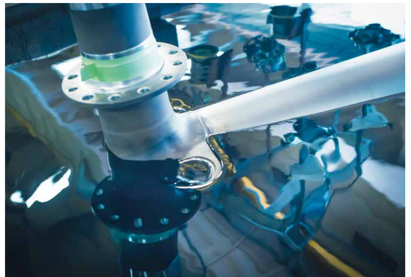
Galvanisierung schützt vor Korrosion und garantiert damit den sicheren Betrieb – hier des Bugfahrwerks eines Flugzeugs
