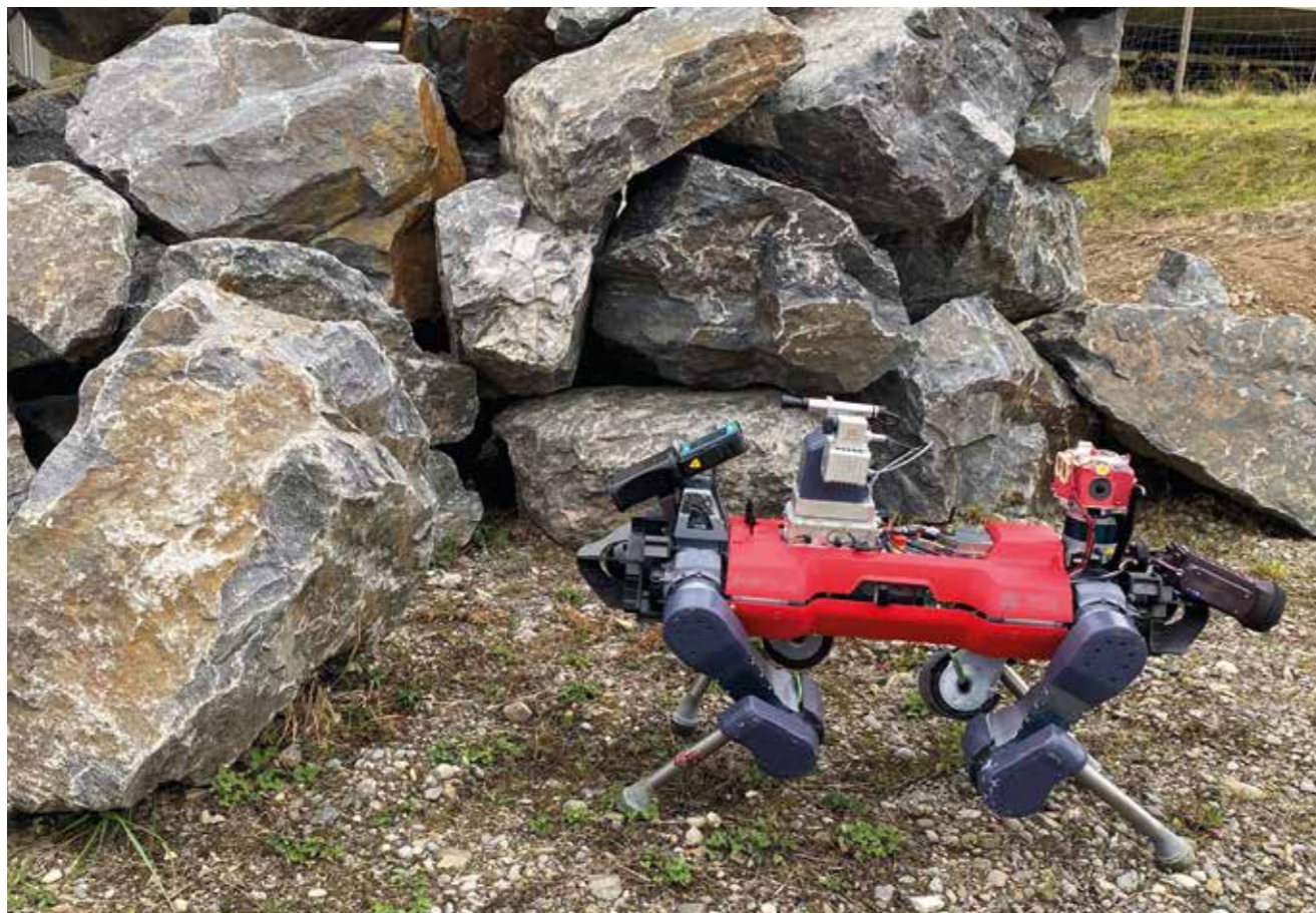
Sprengstoffsuche in rauem Terrain: Das MIRA XTR DS im Einsatz mit dem Quadruped von ANYbotics
