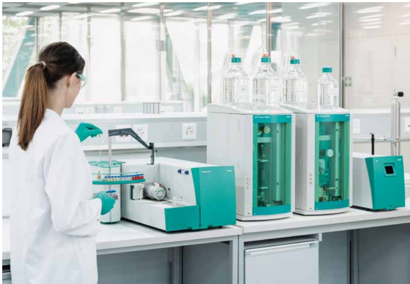
Die Hochtemperaturverbrennung wird eingesetzt, um Korrosionsindikatoren zu messen
