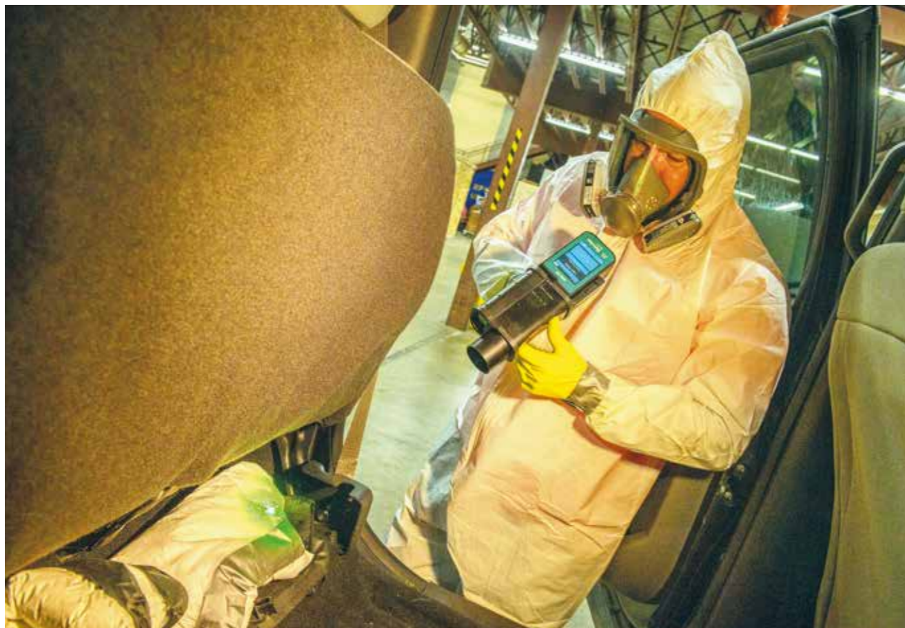
Das MIRA XTR DS ermöglicht es, Chemikalien und Gefahrstoffe berührungslos und aus sicherer Entfernung zu qualifizieren
