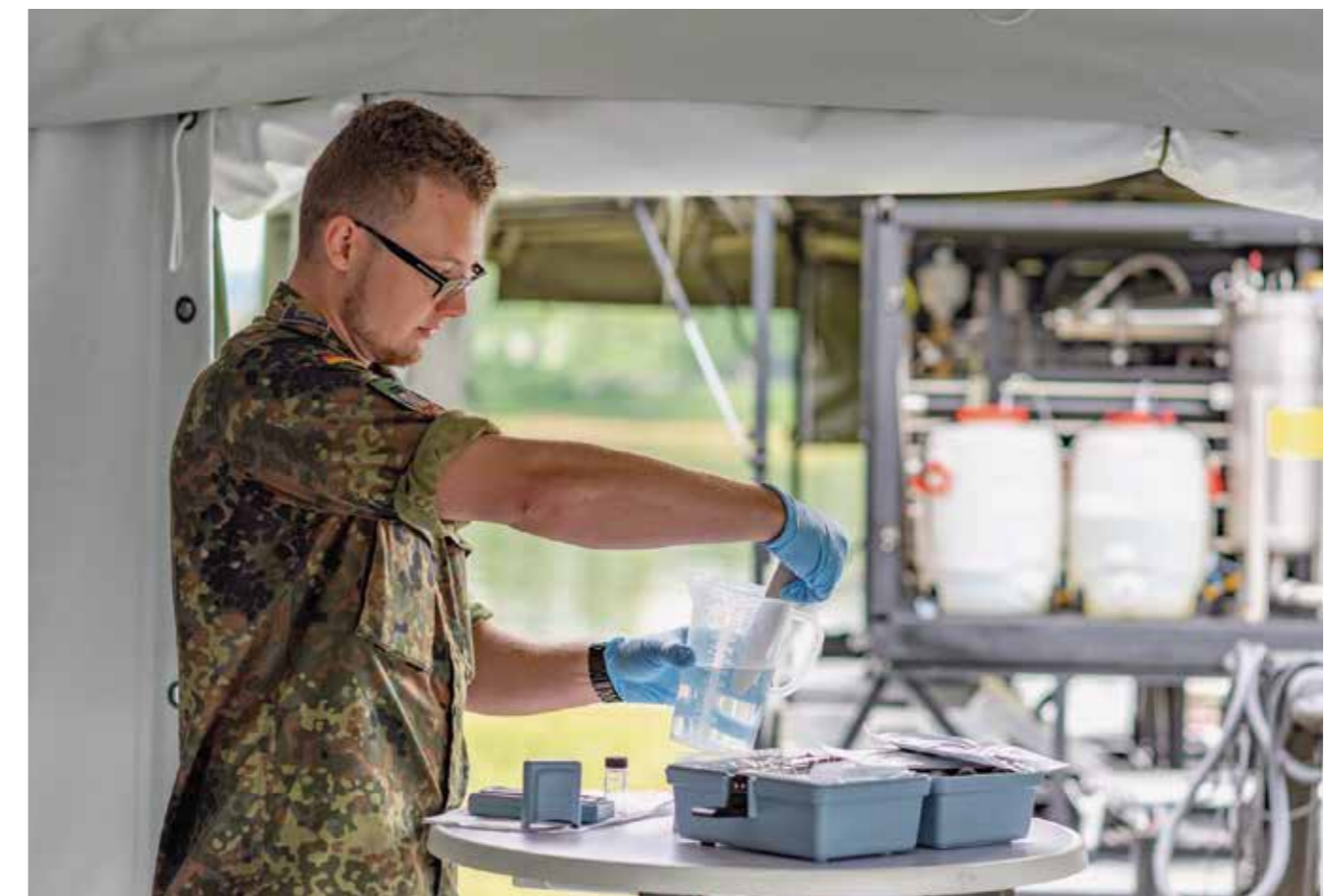
PH- und Leitfähigkeitsmessung im Feld.
