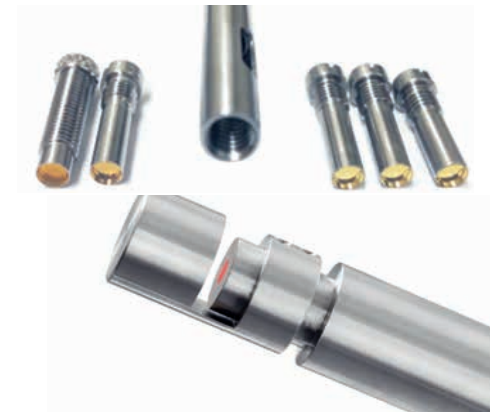
Oben: Einzelfaser-Transflexionssonde mit einem Satz von Spiegeln für definierte OPL (von links nach rechts): 0,5 mm, 1 mm, 2 mm, 5 mm, 10 mm. Unten: MicroBundle-Transflexionssonde mit einstellbarem Spiegel
