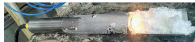
Beispiel für eine berührungslose Sonde, die in eine Außenhülle für flockige Proben eingesetzt wird.
