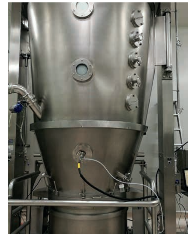
Implementierung einer Löffelsonde in einem Trockner
