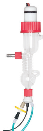
Steam-Jet Aerosol Collector (SJAC) of the 2060 MARGA.
