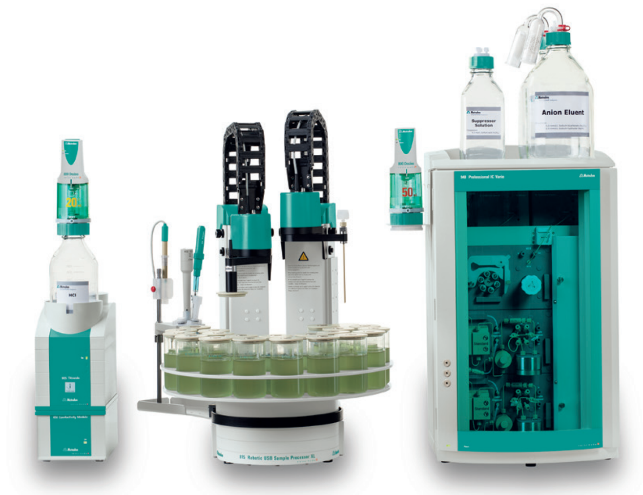
TitriC Vario pro III besteht aus 856 Conductivity Module, zwei 800 Dosinos, 802 Stirrer, 905 Titrand, 815 Robotic USB Sample Processor XL und dem 940 Professional IC Vario für Anionen und Kationen.
