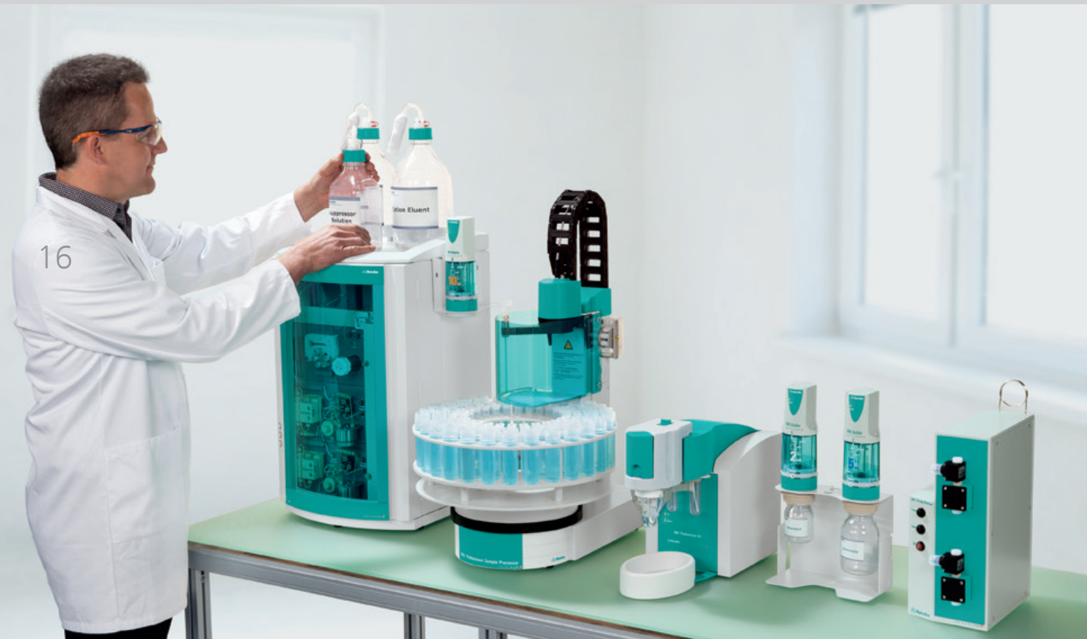
Das vollautomatische VoltIC Vario pro bestehend aus mehreren 800 Dosinos, 884 Professional VA, 858 Professional Sample Processor und 940 Professional IC Vario (v.r.n.l.)
