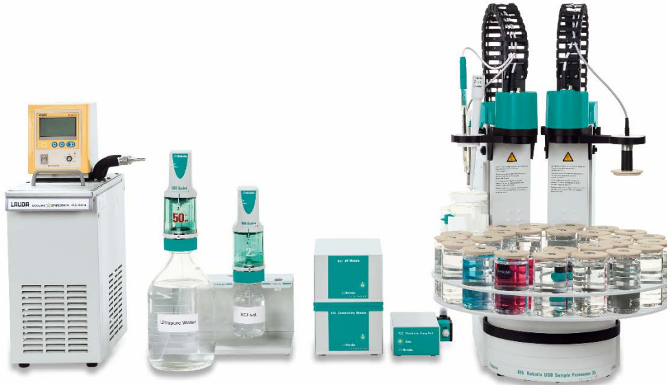
図 4: サーモスタット、867 pH モジュール、856 導電率モジュール、815 Robotic USB サンプルプロセッサ-XL、LL-アクトロードプラス、および導電率測定セルで構成される水の分析システム全体の概要。左のスイングアームは分析に、右のアームは DIS-COVER に使用されます。
