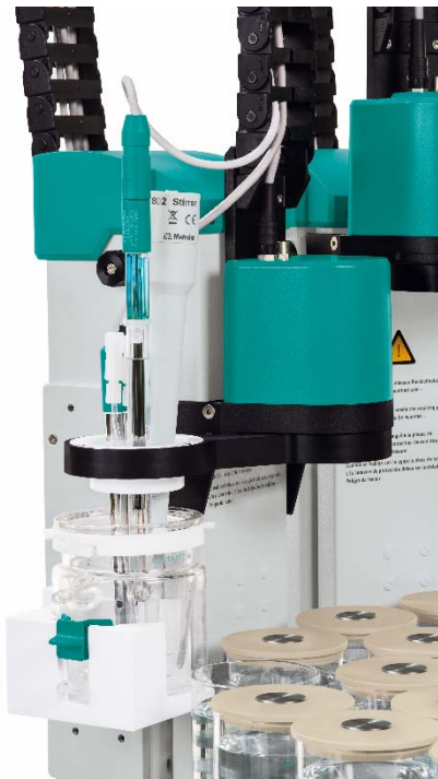
図 6: 外部ビーカー用ホルダー、6.9920.261 と、pH 測定実行中外部に置くセンサーの位置を示しています。
