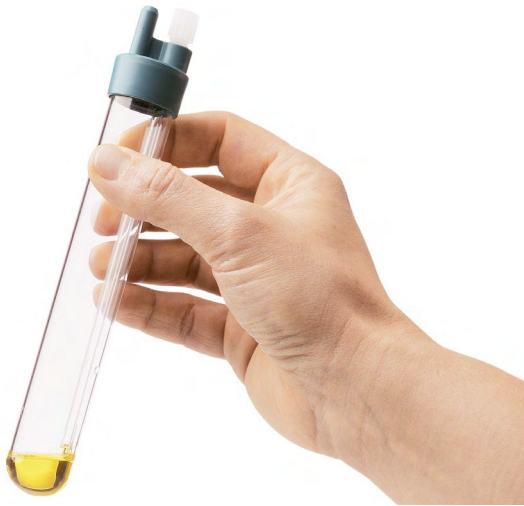
図4.安価な使い捨て反応容器を使用することで、時間のかかる洗浄工程が不要になるので、892ランシマットを効率的に使用できます。
