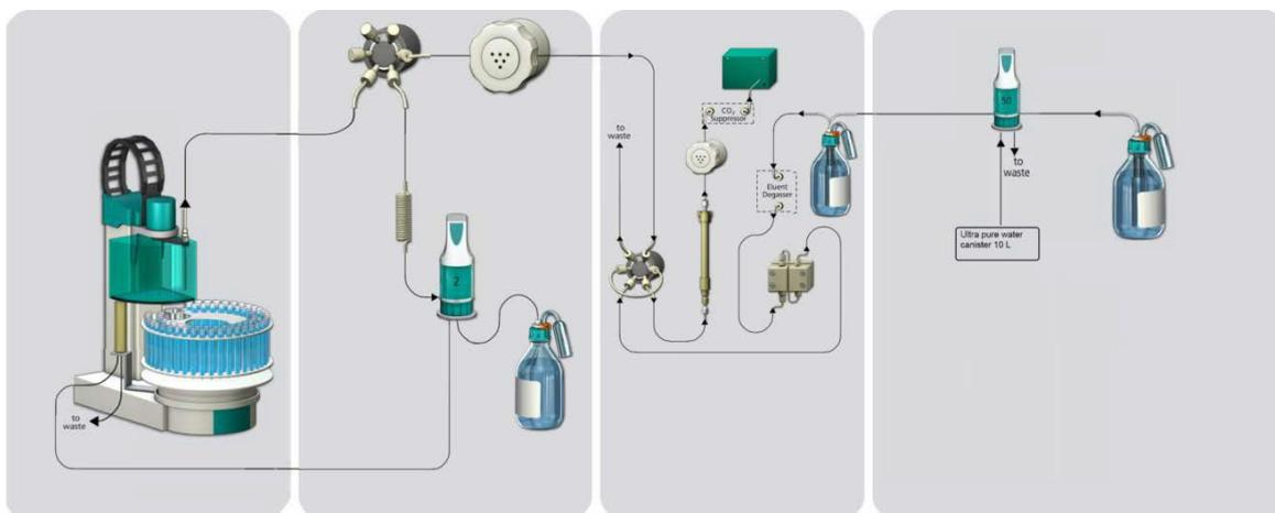
システムセットアップ：洗浄ステーション付オートサンブラ、切替バルブ、トランスファーチューブを接続したリキッドハンドリング用 800 Dosino、中和モジュール（SPM）、MiPT のための 250  $\mu$ L ループを接続した IC システム及びインライン溶離液生成装置で構成されています。
