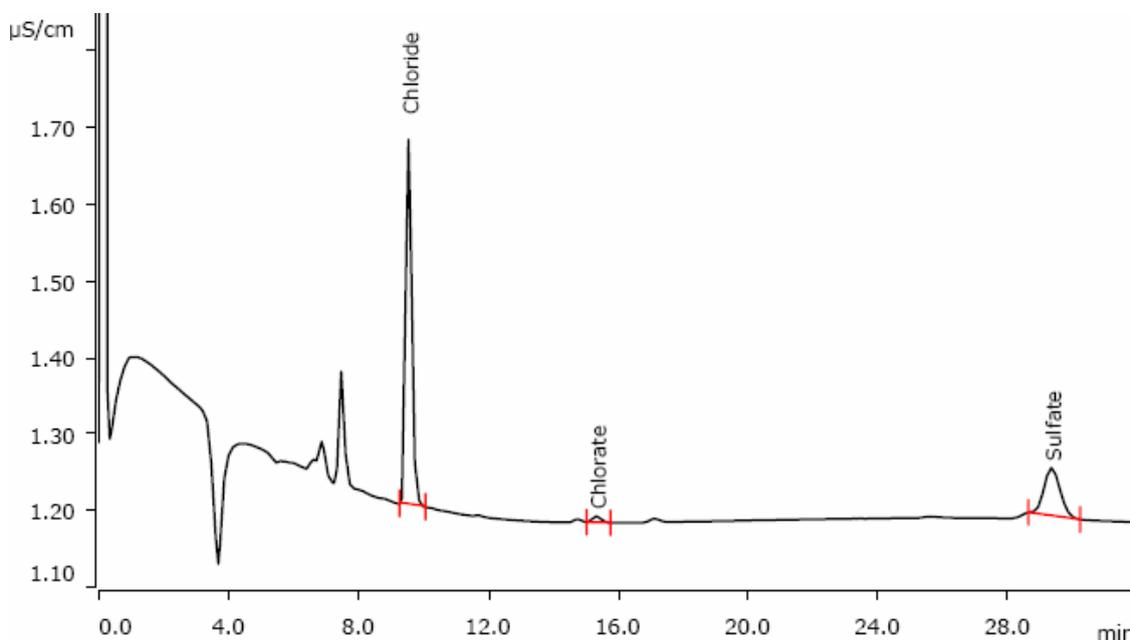
インライン中和テクニックは、水酸化物溶液中のアニオン測定のための確立されたサンプル前処理法です。パーシャルループインジェクションテクニック (MiPT) により、1種類の標準溶液でシステムを校正し、サンプル中のアニオン濃度に応じて注入量を調整することが可能です。この方法は、水酸化カリウム (50%/85%) 及び炭酸カリウム溶液 (83%) 中のアニオン分析に適用されました。
